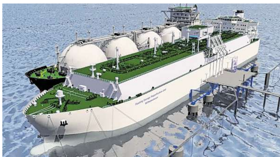
So soll es künftig aussehen: Ein LNG-Tanker (links) legt an der schwimmenden Gasstation an, die das flüssige Erdgas übernimmt und wieder in den gasförmigen Zustand versetzt. FOTO: UNIPER
