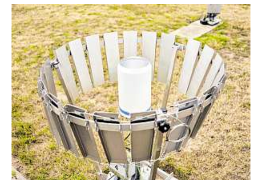
Dieses Gerät misst die Niederschlagsmenge.
