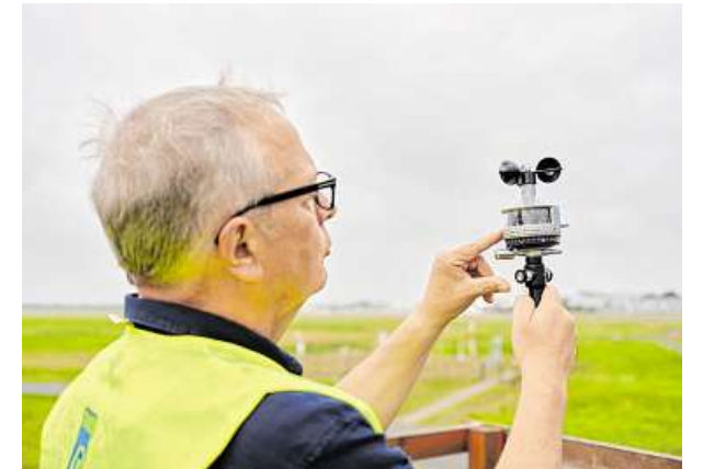
Wenn alle Geräte ausfallen, musste so die Windstärke gemessen werden.
