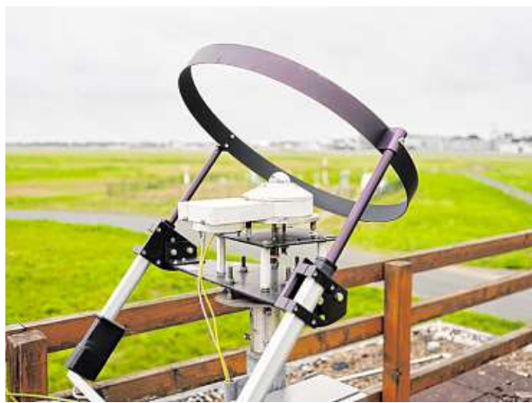
Auf dem Dach steht ein globaler Lichtmesser.
