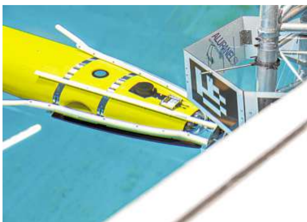
Der Unterwasserroboter muss während seiner Mission selbstständig zur Dockingstation zurückfinden.
